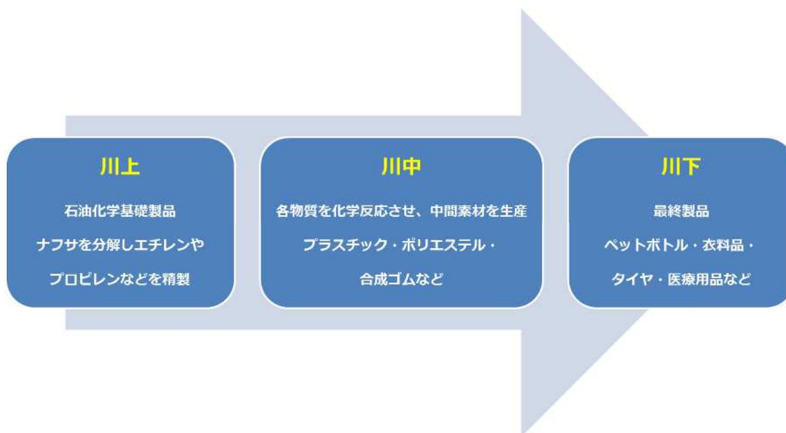
図表 16 ナフサから製品生成までの過程
