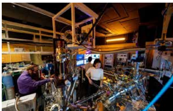
OISTの実験装置。最先端のTR-ARPES（時間・角度分解光電子分光法）顕微鏡を備え、独自に開発された卓上型のXUV（極端紫外線）光源により、フェムト秒領域（1フェムト秒＝1秒の1000兆分の1）の時間スケールで、電子や励起子のイメージングが可能。
