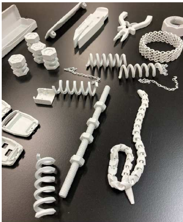
▲3D プリンターで造型された継ぎ目のない立体モデル
