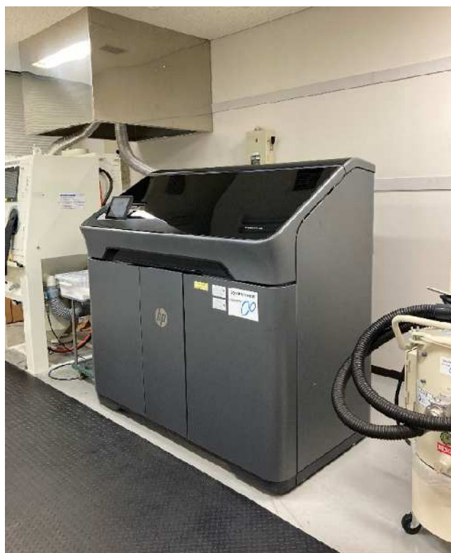
▲粉末溶融積層方式造形機(3D プリンター)
