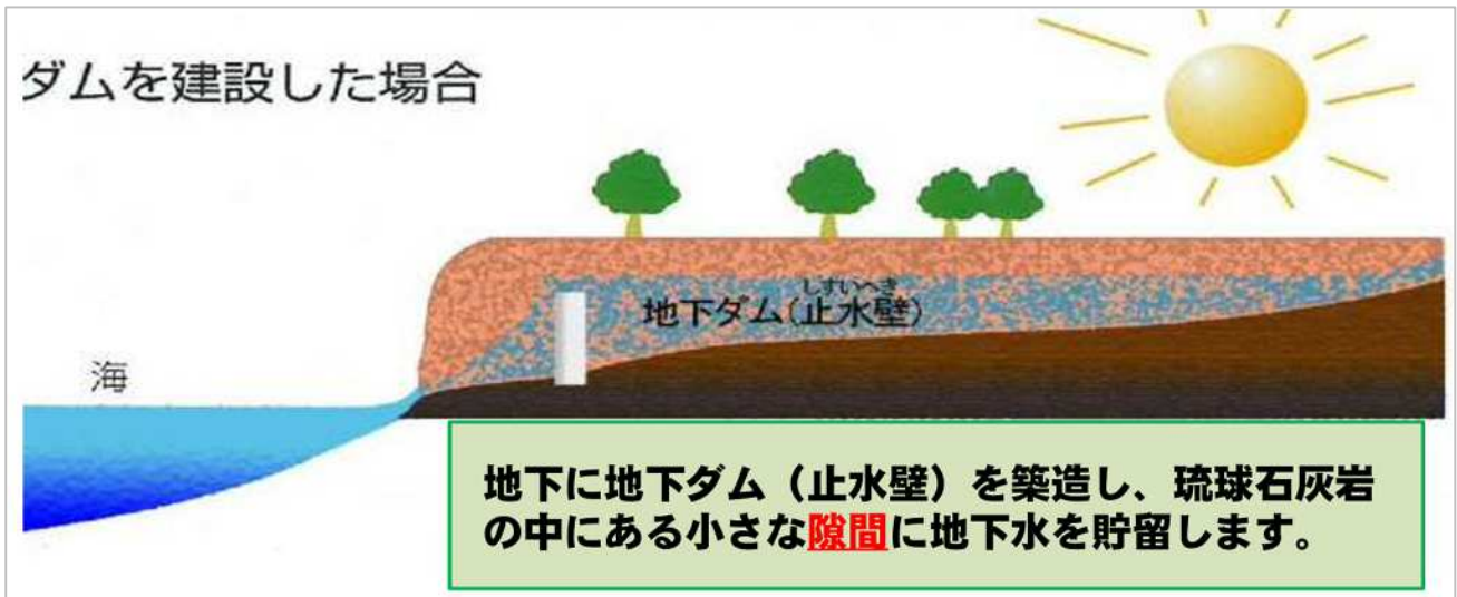
図表 8 : 地下ダムの構造のイメージ
