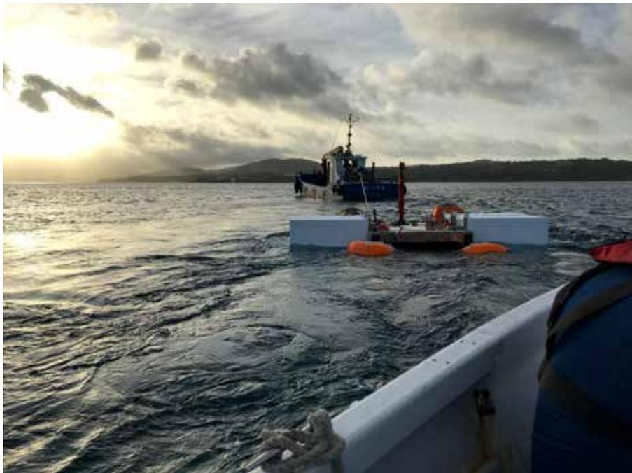
タービン、ダクト、支えのコンクリートブロックを船で曳航して沿岸に運ぶ。その後、潮が引いて波力発電機が着底するのを待った。 提供: OIST
