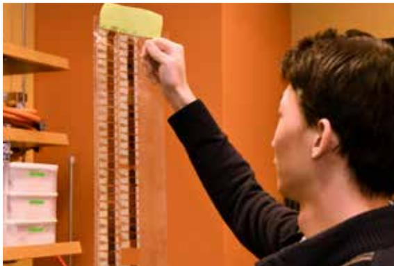
フレキシブルな材料から作製した太陽電池のシートを手に掲げるロンビン・チュウ博士。エネルギー材料と表面科学ユニットでは、家庭にも簡単に導入できる発電するカーテンなどのソーラー技術開発を目指す。
