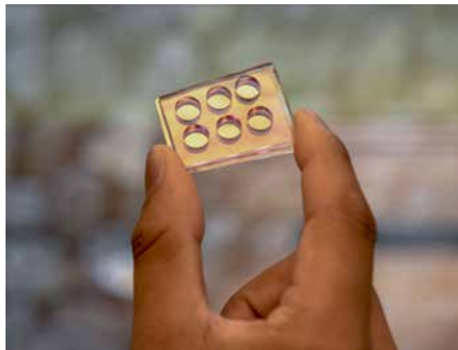
細菌が増殖するとキノコ型ナノ構造が吸収する光の波長が変化するため、センサー基板からの光応答を測定することで細菌試験を行うことができます。 提供: OIST
