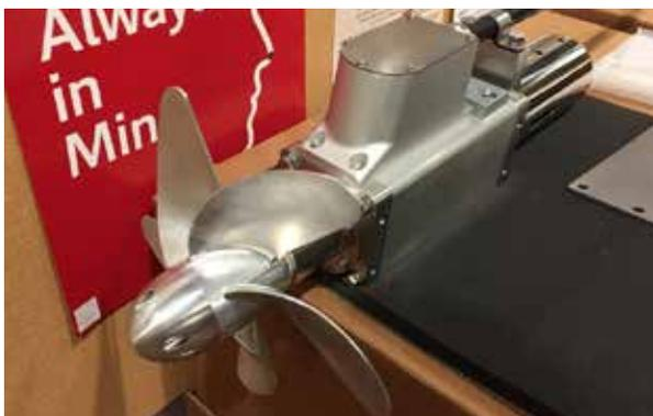
OIST研究室に置かれた、1/2サイズの波力発電機試作機。簡素化のため、試作機のブレードはまだ設計通りの柔軟な素材ではなく、高強度のアルミニウム合金ジュラルミンで作られている。
