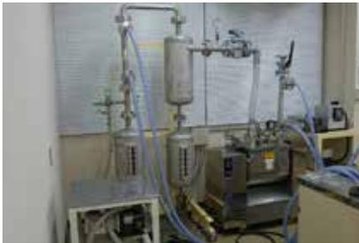
マイクロ波 ポリ乳酸製造装置（補助事業）
