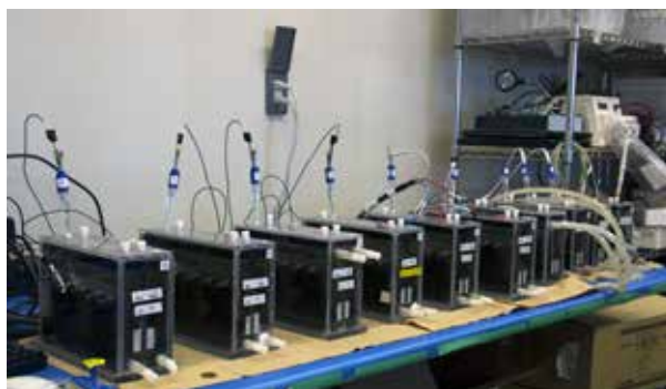
生物システムユニット内にある微生物燃料電池。内部には、沖縄県畜産研究センターで採取した養豚排水が入っている。
