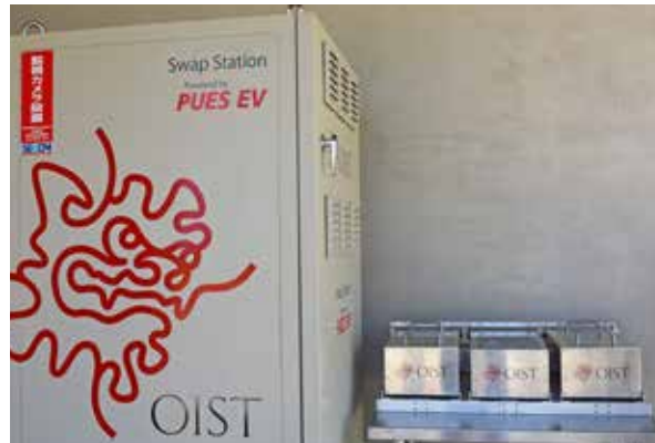
電気自動車（EV）用バッテリー充電システム（スワップステーション）
