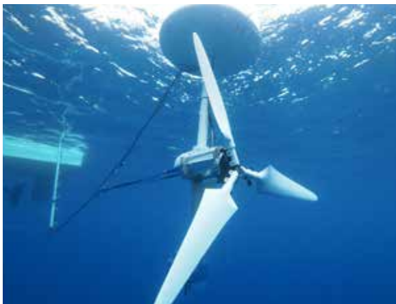
海流発電機の試作品を用いた曳航実験
