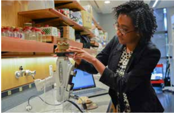
OIST研究員のアニャ・ダニ氏は、持ち運び可能な蛍光X線分析装置を用いて、焼き物の元素組成を解析しました。
