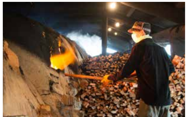
炎の大きさを見極め、数分ごとに薪をくべます。1つの窯（燃焼室）の焼成には約4時間かかります。
