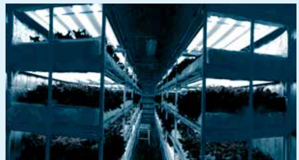
LED光源を利用した完全人工光型植物工場の内部
