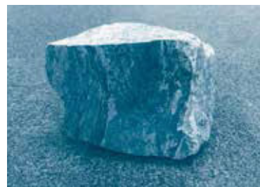
本島北部の古生代石灰岩：コンクリート骨材やセメントの原材料に使用されています。
