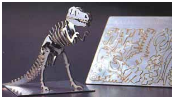
レーザー切断加工機によりカット、組立てられた恐竜模型
