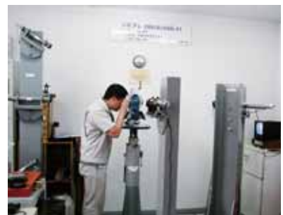
測量機器検定の様子
