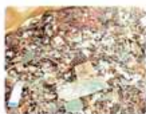
基板も破砕機で細かく処理します。
